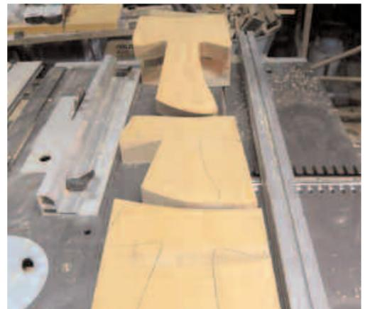
*Le dessin stylisé du tau fait l'objet d'un gabarit en contreplaqué, permettant le tracé de la linéature de l'objet. Ci-dessus les étapes successives de fabrication.*
